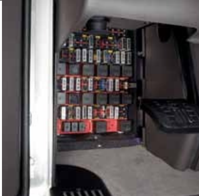
La caja de distribución eléctrica del T800 reúne todos los elementos de protección de circuitos —fusibles, relés e interruptores— en una ubicación de fácil acceso.
