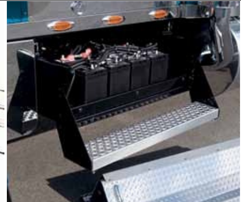
Aquí hay otra razón por la que los Kenworth son tan confiables: baterías de 12 voltios libres de mantenimiento, firmemente sujetas y montadas en el lado izquierdo, cerca del motor de arranque para minimizar la caída de voltaje.
